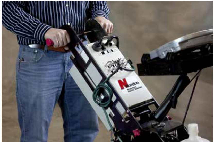
One Pass: un sistema de inspección de rieles por ultrasonido
