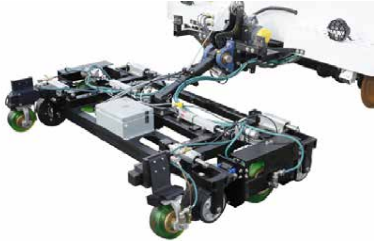
Flex: carro de inspección montado en el vehículo
