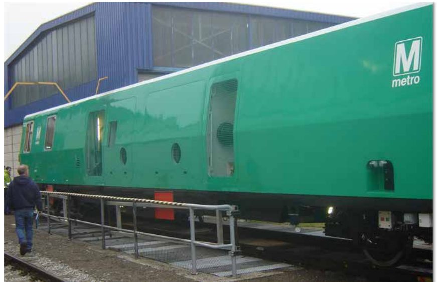
Vehículo de montaje en riel con un sistema de detección de fallas en los rieles instalado
